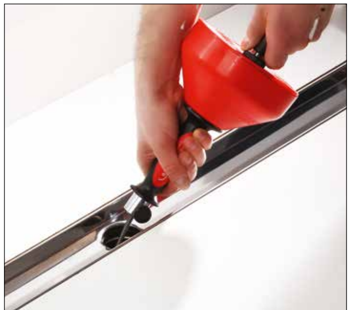
Abflussleitung mit kleiner Handspirale säubern
