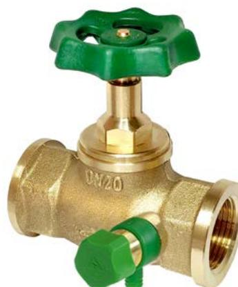
**Material:** Messing CW 617 N mit reduziertem Bleianteil nach DIN 50930-6 und UBA-Liste
